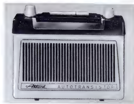
Bild 1. Der Universal-Reise-Auto-Heimempfänger „Akkord-Autotransistor“. Der oben sichtbare Bügel wird beim Betrieb als Reiseempfänger nach oben geklappt und dient als Traggriff
