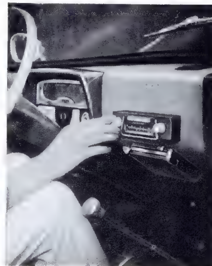
Bild 2. Das Gerät wird im Kraftwagen in eine fachartige Haltevorrichtung eingeschoben und dabei automatisch an die Fahrzeugantenne, die Bordbatterie und gegebenenfalls an einen größeren Wagenlautsprecher angeschlossen
